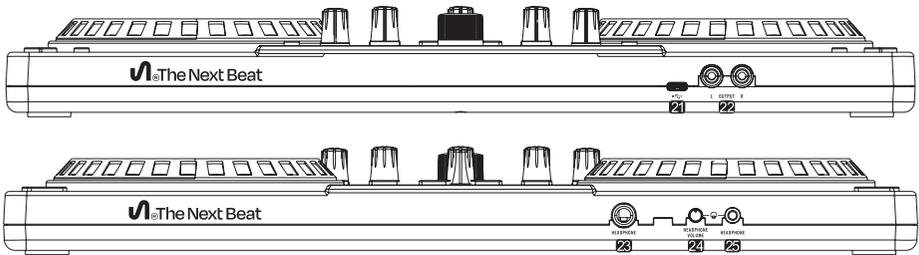
21. **USB CONNECTOR** - Für den Anschluss des DJ-Controllers an Ihren Computer mit USB-C.
